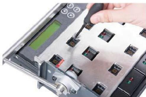
Ø 所有卡片都置放到编程器完成后。将把手由上往下拉，并确认所有模块已经固定好。
