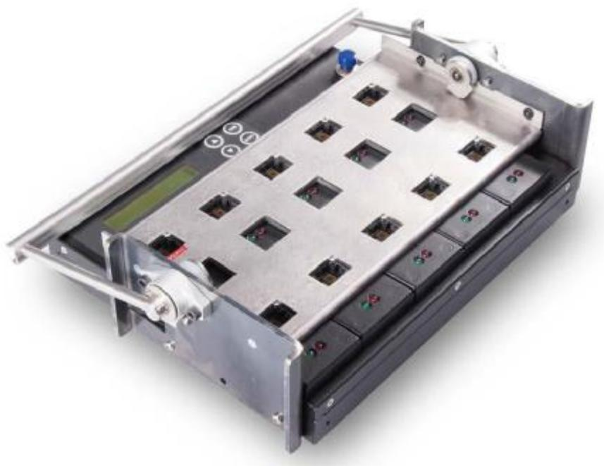
Ø 使用IC真空吸笔吸住eMMC卡。将卡片置入接口。固定好，接着一个一个置入接口。
